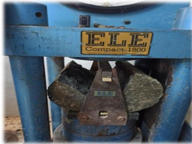
شكل (18): العينة في جهاز اختبار مقاومة الشد الإنشطاري
