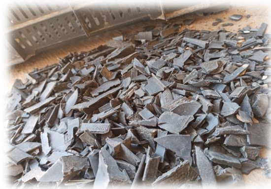
شكل (8) : نفايات البلاستيك بعد تكسيرها وتحويلها الى ركام
