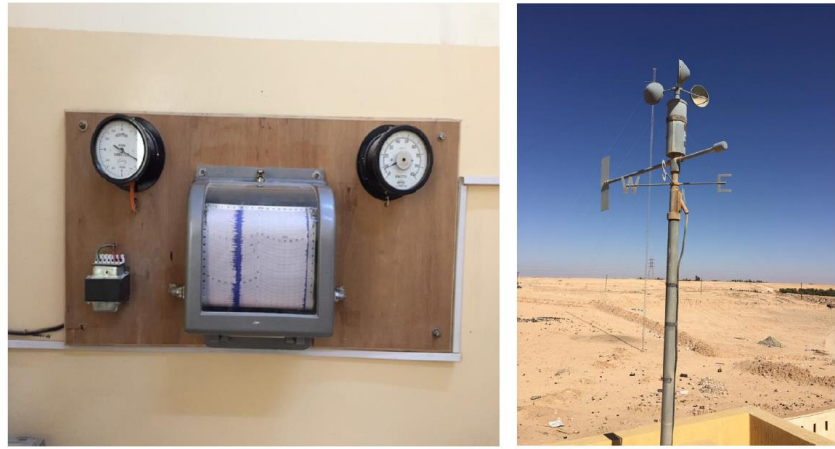
شكل (14) جهاز الأنيمومتر لقياس سرعة و اتجاه الرياح
