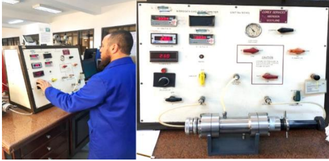
الشكل 7: جهاز قياس النفاذية باستخدام غاز النيتروجين (Nitrogen Gas Permeameter).
