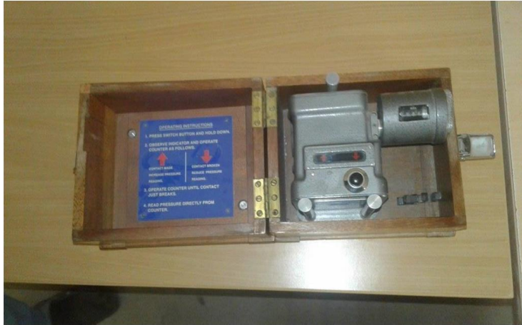
الشكل (12) جهاز الباروميتر المستخدم في قياس الضغط
