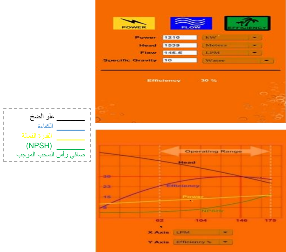
شكل رقم (4) كفاءة ومنحني التشغيل لمضخة تغذية الغلاية الرئيسية
