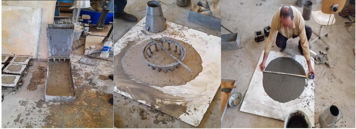
يوضح الشكل (3) اختبارات الخواص الطرية للخرسانة ذاتية الدمك بمعمل قسم الهندسة المدنية جامعة وادي الشاطئ
