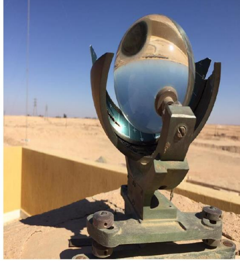
الشكل (7) مسجل كامبل - ستوكس المستخدم لرصد سطوع الشمس
