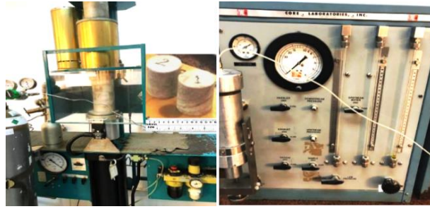
الشكل 6: الجهاز العملي لقياس المسامية بالهيليوم (Helium Porosimeter).
