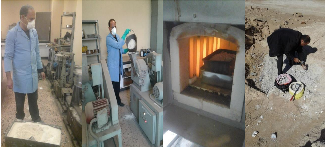
الشكل (1) صورة توضح موقع استجلاب عينة البوزولانا منطقة سبها تم تكليسها وطحنها ونخلها بمعمل الجودة بمصنع الحديد والصلب بمصراتة
