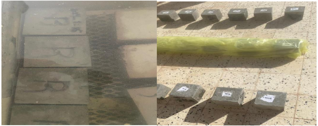
شكل رقم (3) : كيفية معالجة العينات بالطرق المعتمدة بالدراسة
