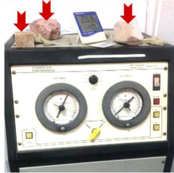
الشكل 8: جهاز إختبار مقاومة الضغط (المعهد الليبي للنفط، طرابلس - ليبيا).
