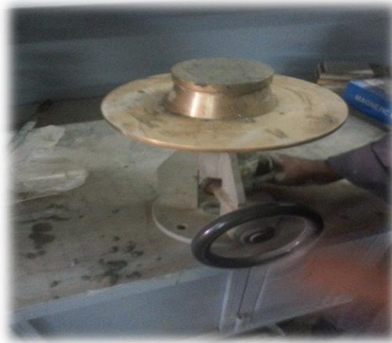
شكل (12) : العينة في جهاز الانسياب
