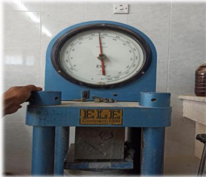
شكل (16) : العينة في جهاز اختبار الضغط
