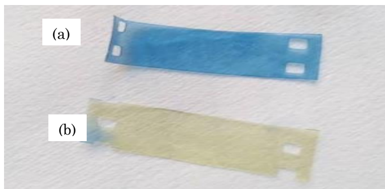
الشكل (5): صورة المستشعر (a) قبل و (b) بعد التفاعل مع الالبومين
